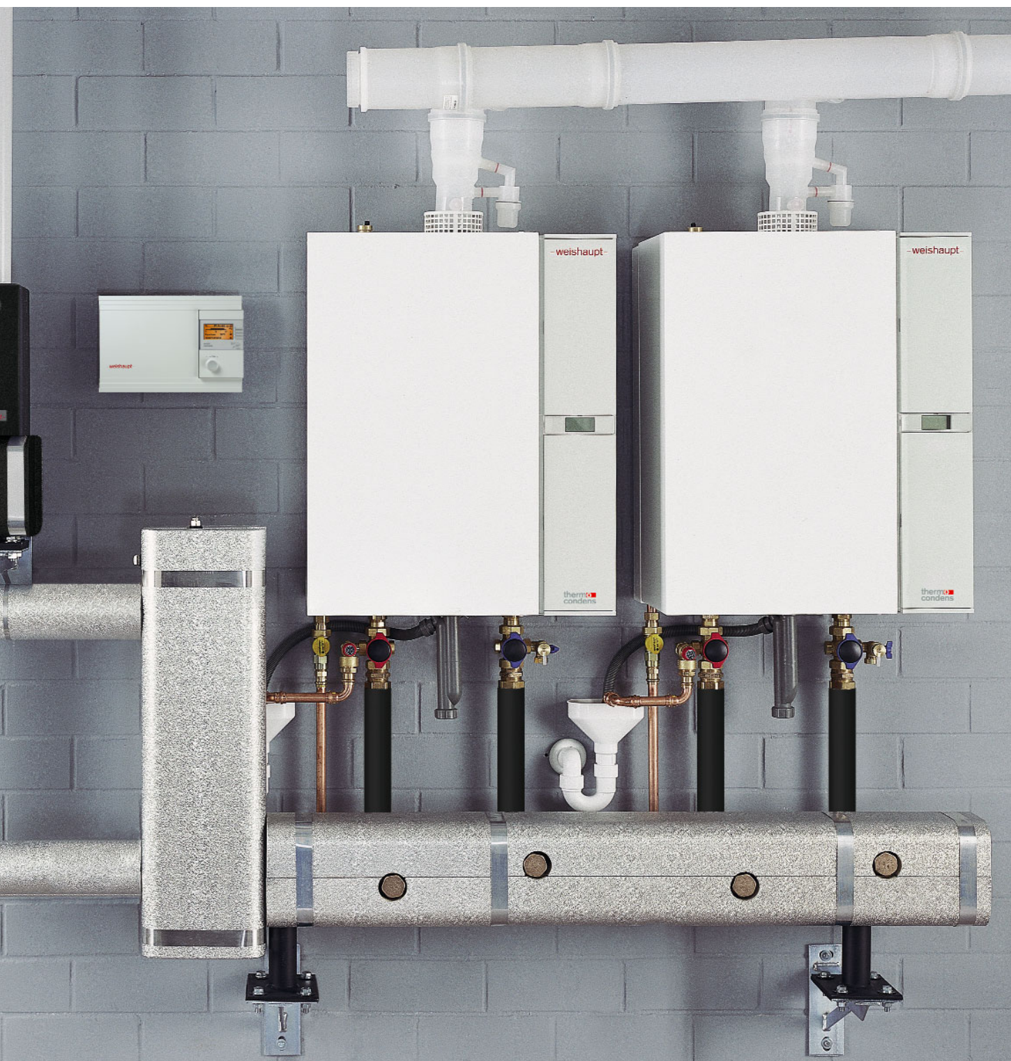
Bij een Thermo Condens-cascade met 240 kW begint het minimum modulatievermogen bij 5% en wordt traploos verhoogd tot op het totale vermogen
