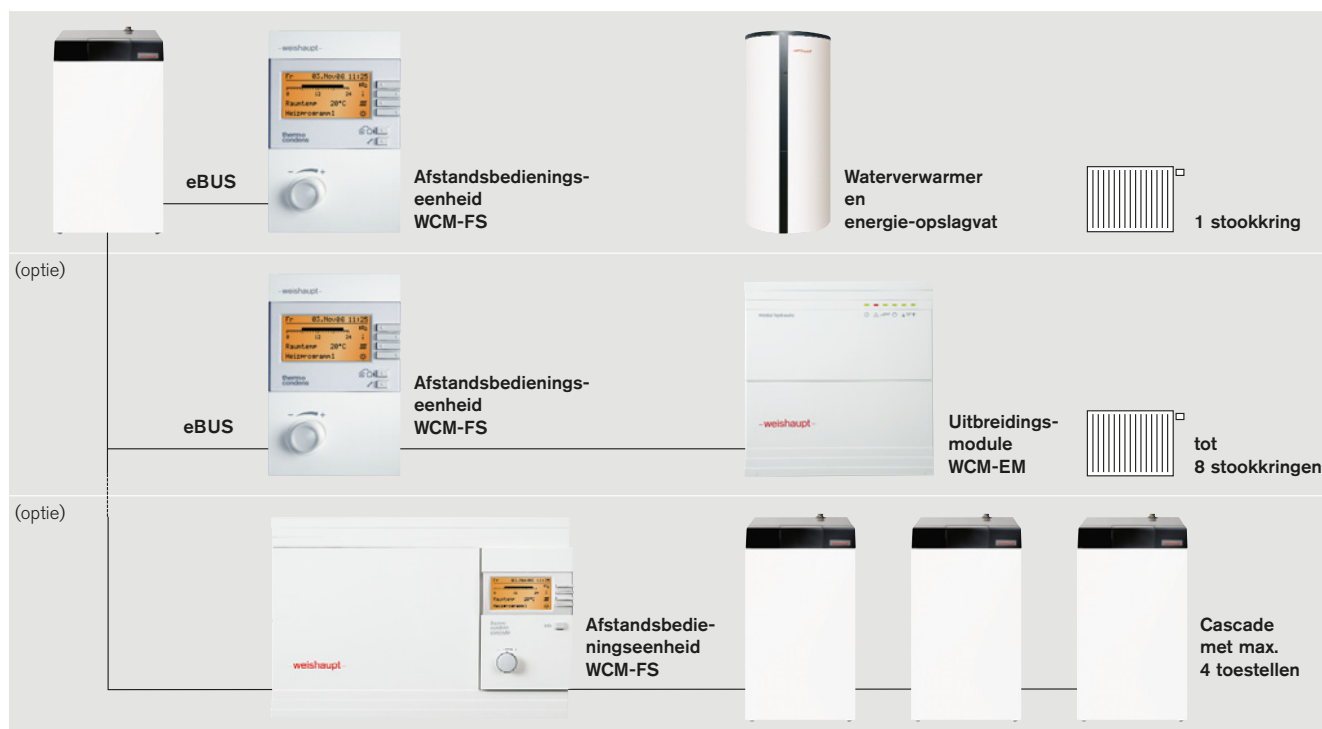
Het regelsysteem WCM is modulair opgebouwd
